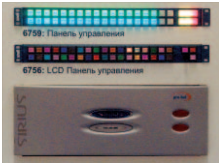
Коммутатор Snell Sirius 610 и панели управления
